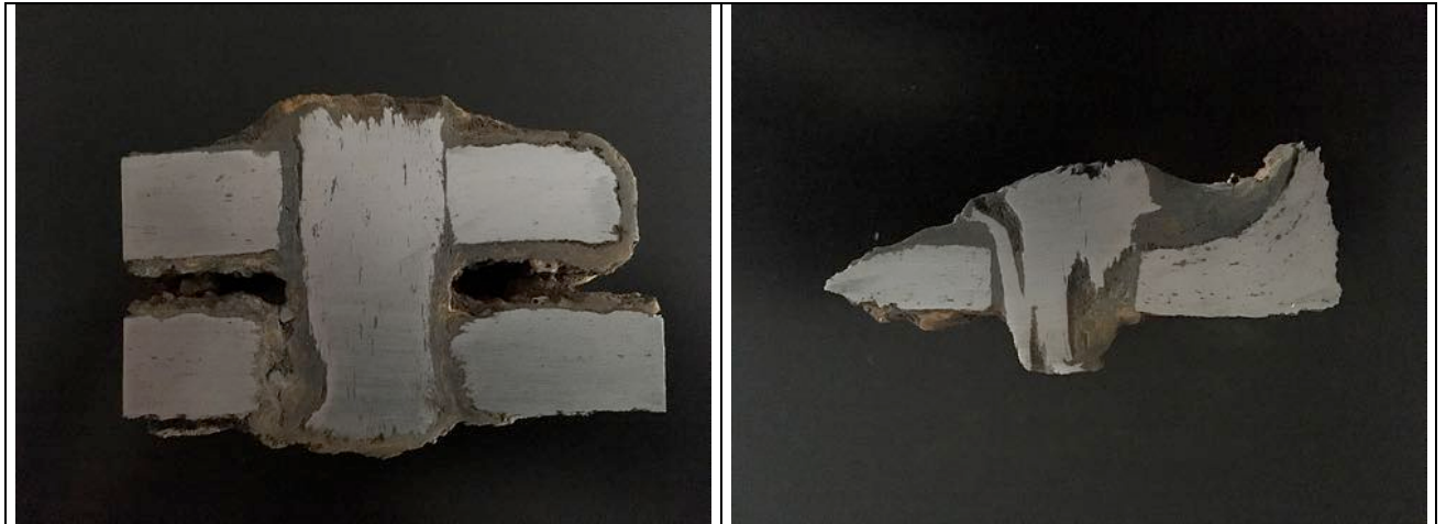
Figure 3. Coupes longitudinales sur rivets de l'échantillon A (gauche) et de l'échantillon B (droite).
